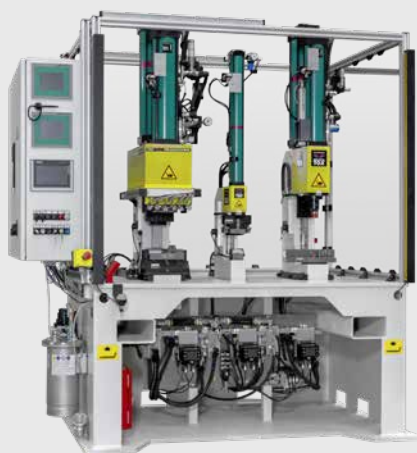
Presse TOX® pour l'eClinchage de composants de sécurité.
